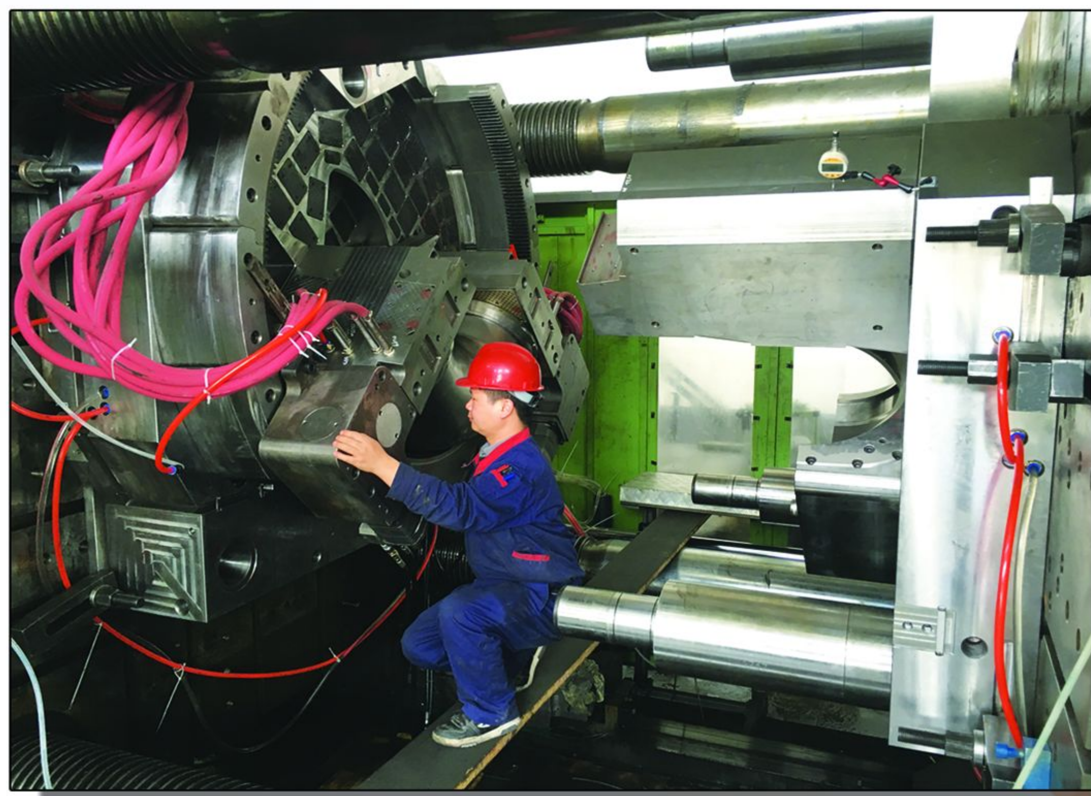
DN355/400/450/500弯头模具 SDR11/17 HDPE/PP 16款互换 产品一次成型，无后加工
